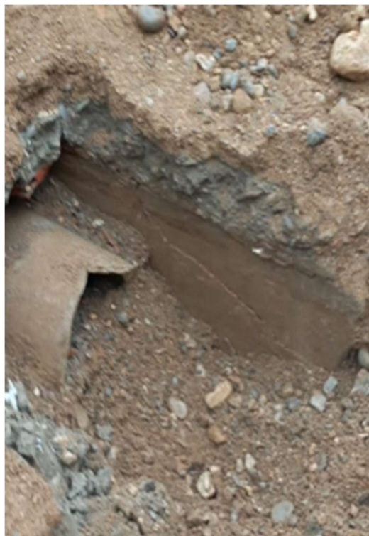
4.- Rotura tubería de FIBROCEMENTO al paso por el barranco de La Baiba
