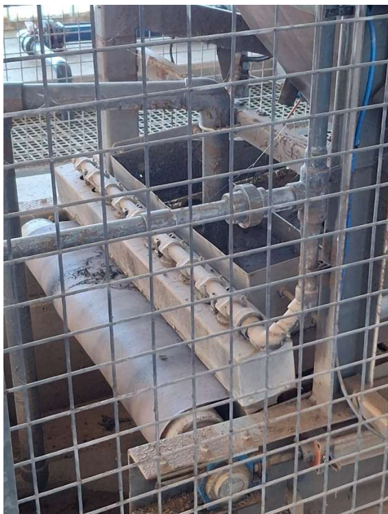
12.- y 13.-Los equipos han quedado inservibles después de tanto tiempo sumergidos
