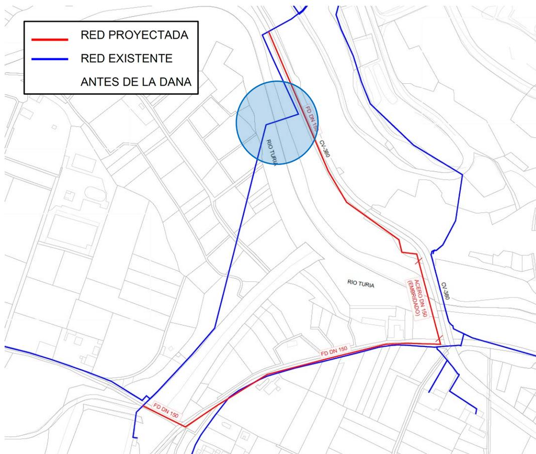
La tubería existente antes de la DANA (representada con línea azul en la imagen) era de FC de 200 mm de diámetro interior y, dada la fragilidad de este material, se considera necesario sustituir también los tramos aguas abajo y aguas arriba del cruce para garantizar el servicio, ya que se anticipan roturas en otros puntos debidas a los
