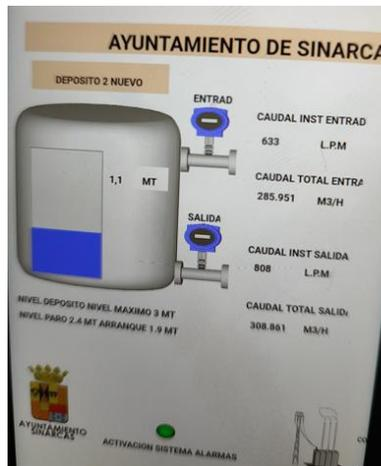
Implantación sondas nivel en SCADA
