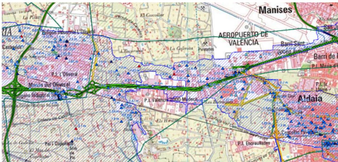
Figura 86 Huella de la inundación y niveles máximos alcanzados por el agua. Fuente: ICV
