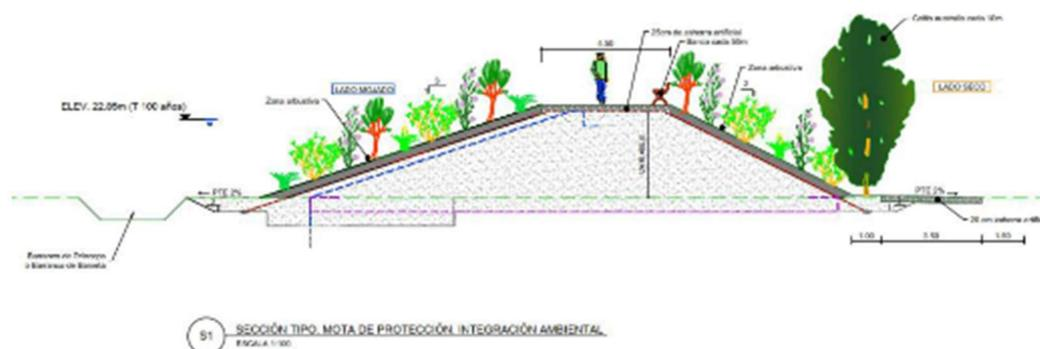
Figura 77 Sección tipo de la mota de protección
