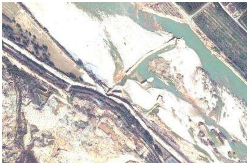
*Figura 47 Ejemplo de azud demolido parcialmente en el río Magro tras la DANA. Una gran parte de los azudes han sido destruidos o gravemente afectados, así como la mayor parte de los pasos de vías de comunicación existentes para los caminos locales.*
