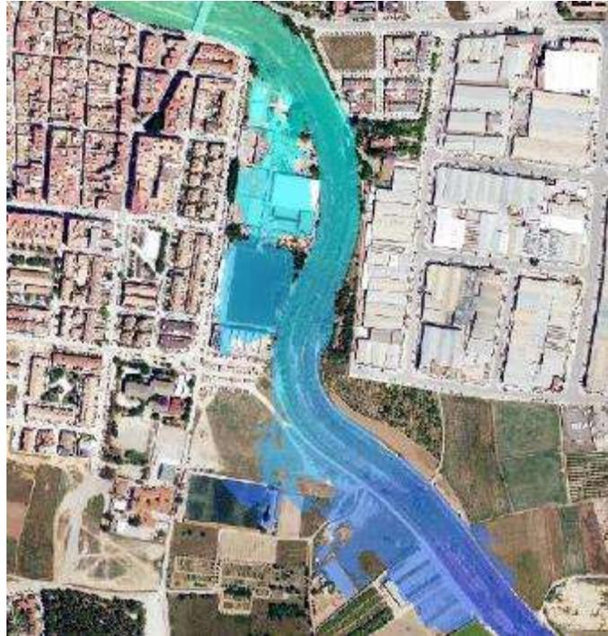
*Figura 105 Calados para un  $Q=1.000 \text{ m}^3/\text{s}$  en Paiporta sin considerar el efecto de los puentes*
