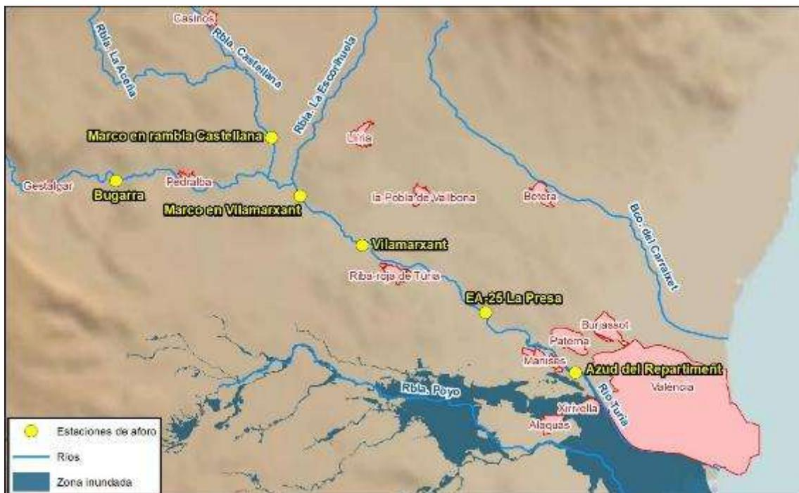
Figura 28 Estaciones de aforo en el tramo bajo y medio del Turia
