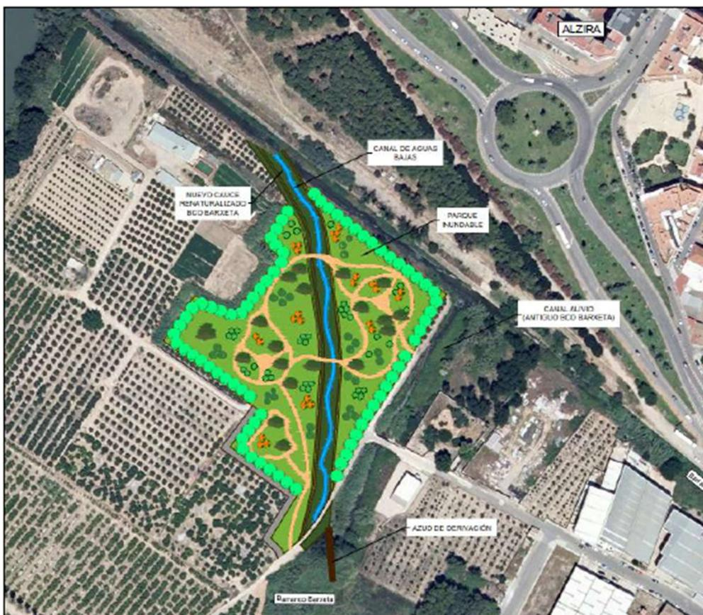
Figura 75 Planta de zona de laminación propuesta
