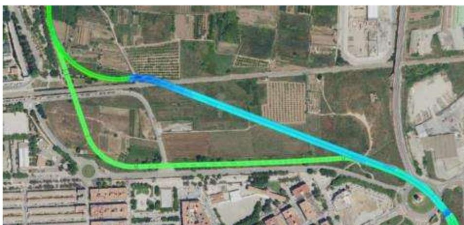
Figura 83 Modificación del trazado en planta para la facilitar la incorporación del cauce de Aldaia (CEDEX, 2025a)
