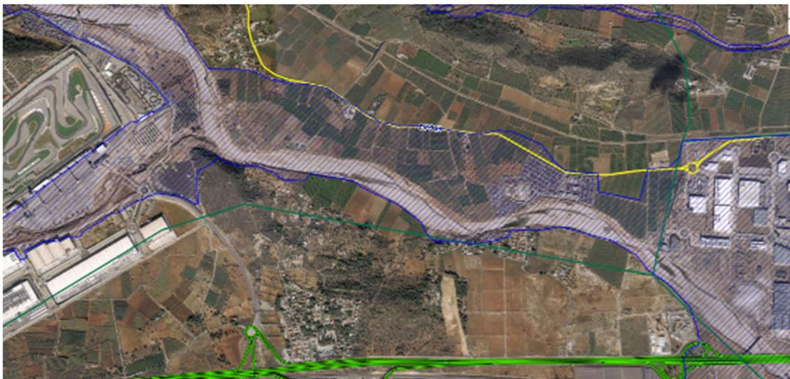
Figura 94 Huella de la inundación aguas arriba del cruce del barranco del Poyo con la A-3 y posible zona de almacenamiento controlado
