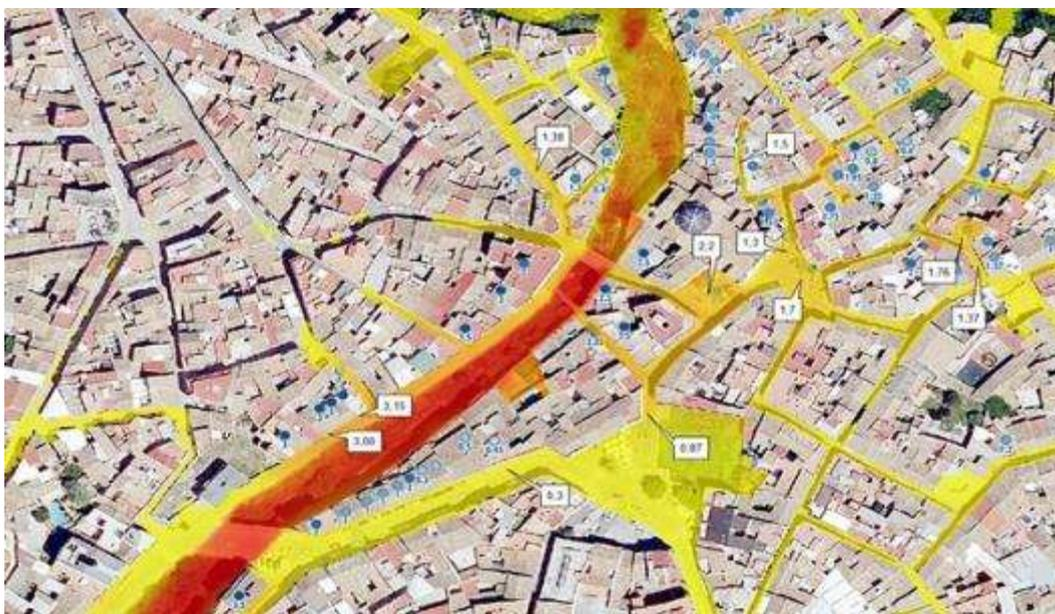
Figura 90 Simulación 2D de niveles máximos de inundación y contraste con valores observados
