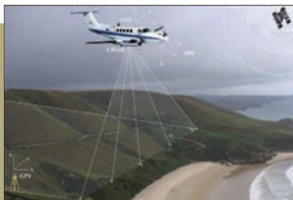
Figura 1. Toma de datos del LIDAR (fuente: DIELMO).
