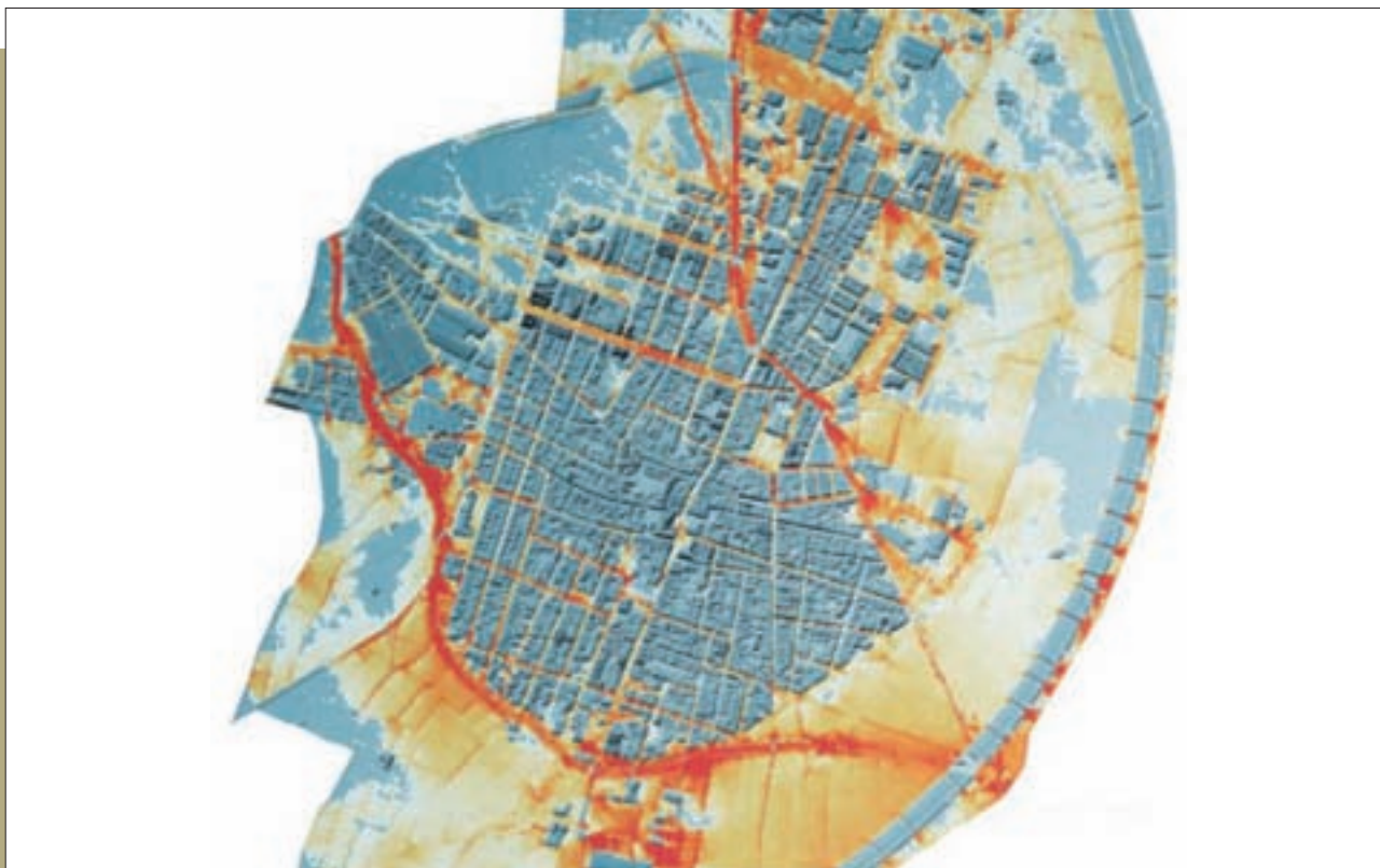
Figura 6. Resultados de la modelización con GUAD 2D: velocidades. Fuente: Análisis estratégico sobre inundaciones en el entorno de Alginet (Valencia). Confederación Hidrográfica del Júcar. INCLAM S.A.
