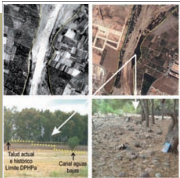
Figura 170. Los límites del cauce histórico continúan reconociéndose en la actualidad. Engloban el canal de aguas bajas y una unidad intermedia con evidencias de actividad reciente y reiterada (imagen inferior derecha). Dicha unidad formará parte del DHPa, incluso aunque el canal de aguas bajas haya sido dragado (río Palancia, Valencia).
