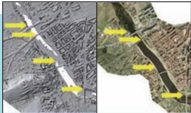
Figura 25. Identificación y posible determinación de las cotas de los puentes a partir del MDE del LIDAR y de la ortofoto.
