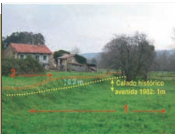
Figura 180. La línea roja separa dos unidades inundables: la número 1 en la zona más baja, a la derecha de la imagen y la 2, más elevada, a la izquierda. En la unidad 1 se ha constatado el calado de un evento en el año 1982, a 20 cm de afectar la unidad número 2. Dado que la diferencia en sección entre el calado de este evento y el necesario para inundar la unidad 2 no es significativa, se asigna una inundabilidad baja a esta última.
