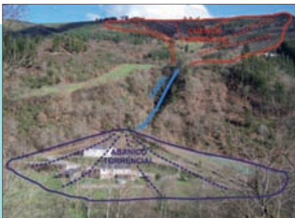
Figura 184. Elementos morfológicos básicos que componen un sistema torrencial típico: arroyo El Infierno, Ibias (Asturias).
