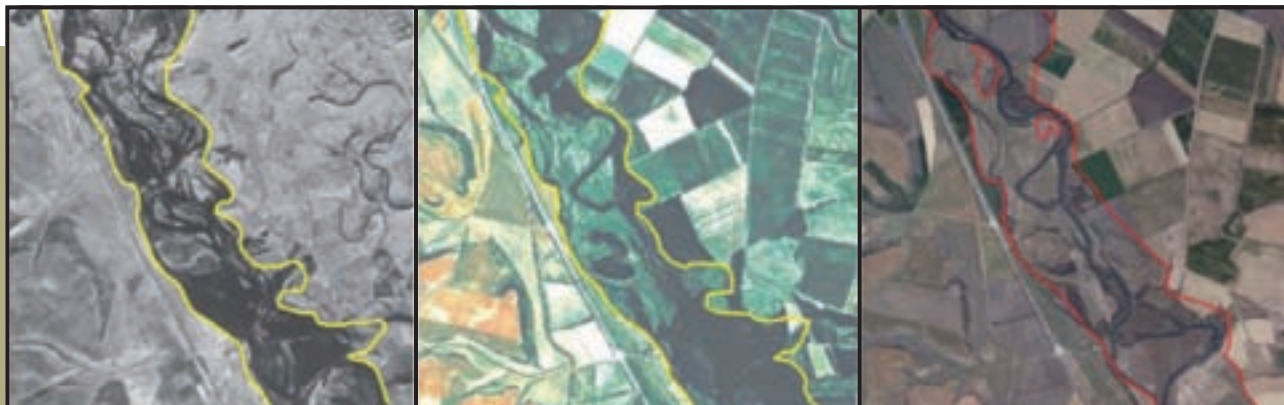
Figura 172. En amarillo, la envolvente del cauce histórico sobre fotografía de 1956 (izquierda) y 2003 (centro). Superficie afectada por una avenida con periodo de retorno inferior a 3 años sobre fotografía de 2007 (derecha).
