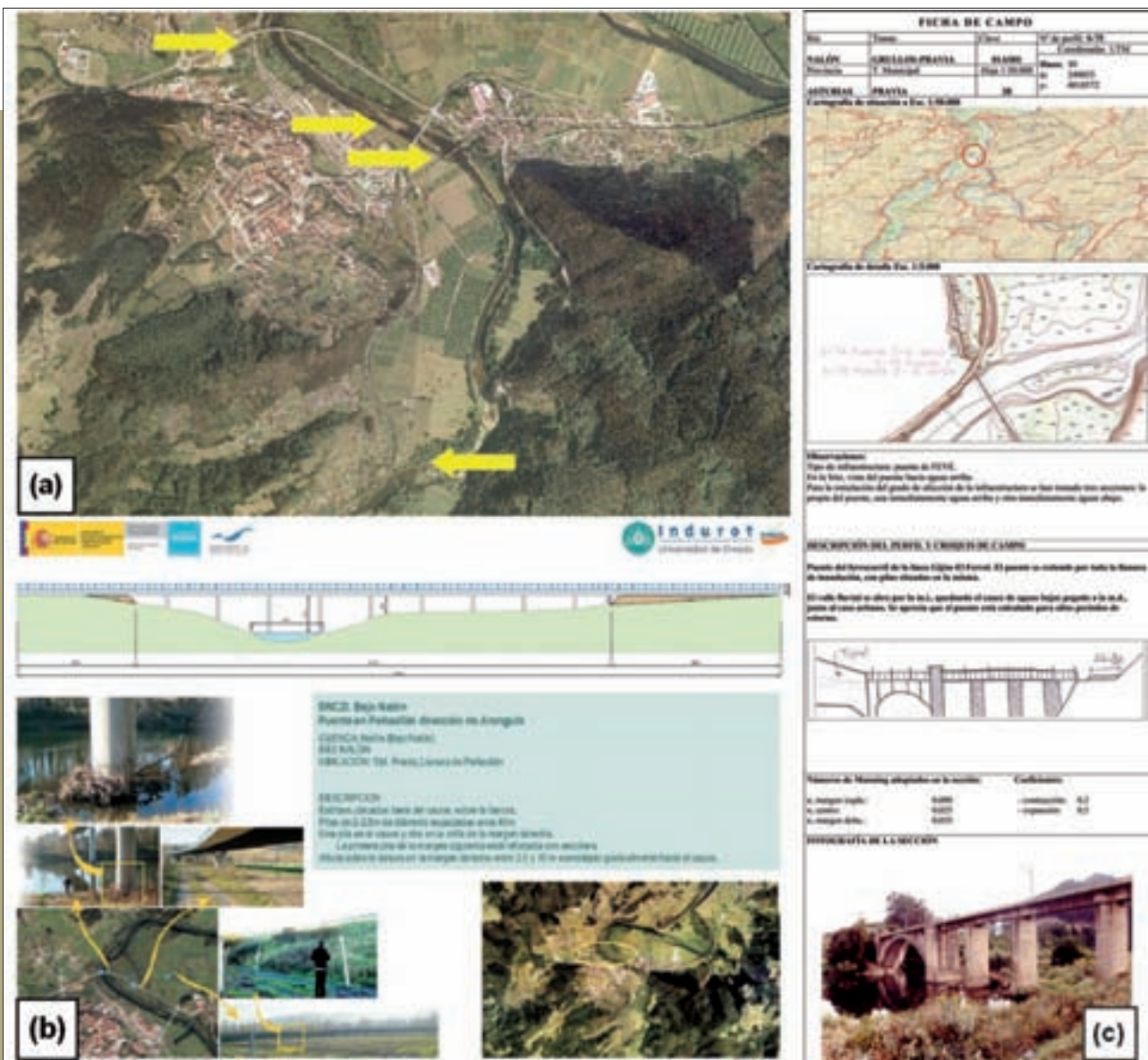
Figura 24. Identificación de puentes en el tramo bajo del río Nalón y ejemplos de croquis de los mismos: (a) puentes identificados, (b) croquis del puente de Cudillero (información facilitada por INDUROT), (c) croquis del puente de FEVE (tomado de la Memoria del Proyecto Linde).
