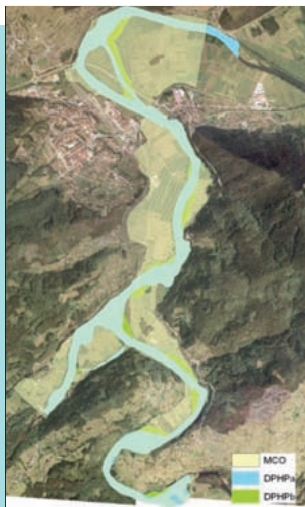
Figura 258. Resultado de la modelización hidráulica de la MCO y límites del DPHPa y DPHPb definidos en el análisis histórico y geomorfológico.
