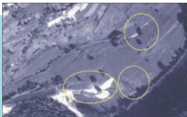
Figura 100. Rotura de orilla acompañada del depósito sobre la llanura de dos lóbulos de derrame. También se reconocen otros depósitos menores. Fotografía aérea del año 1963 realizada un mes después de una inundación (bajo Nalón, Asturias).
