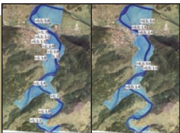
Figura 247. Resultados de la modelización hidráulica de las avenidas de 1998 (izquierda) y 2003 (derecha) junto con los puntos para los cuales se disponía de información sobre calados en el tramo bajo del río Nalón. Se identifican los calados (m) de las referencias históricas, en primer lugar, y resultantes de la modelización, en segundo lugar.
