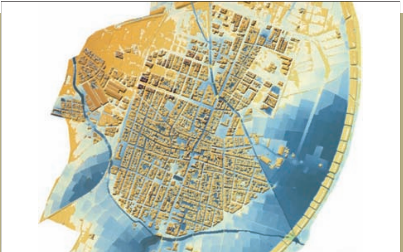
Figura 5. Resultados de la modelización con GUAD 2D: calados. Fuente: Análisis estratégico sobre inundaciones en el entorno de Alginet (Valencia) . Confederación Hidrográfica del Júcar. INCLAM S.A.
