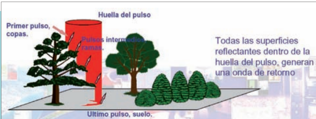
Figura 2. Toma de datos del LIDAR (fuente: INCLAM).
