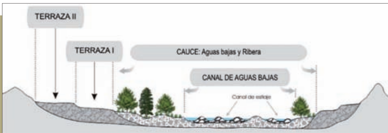
Figura 168. Los límites del cauce engloban el canal de estiaje, el canal de aguas bajas y, cuando existe, la franja de ribera dinámicamente conectada a las anteriores, la cual, en muchos casos, ha formado parte del cauce histórico. Modificado de Pedraza (1996).
