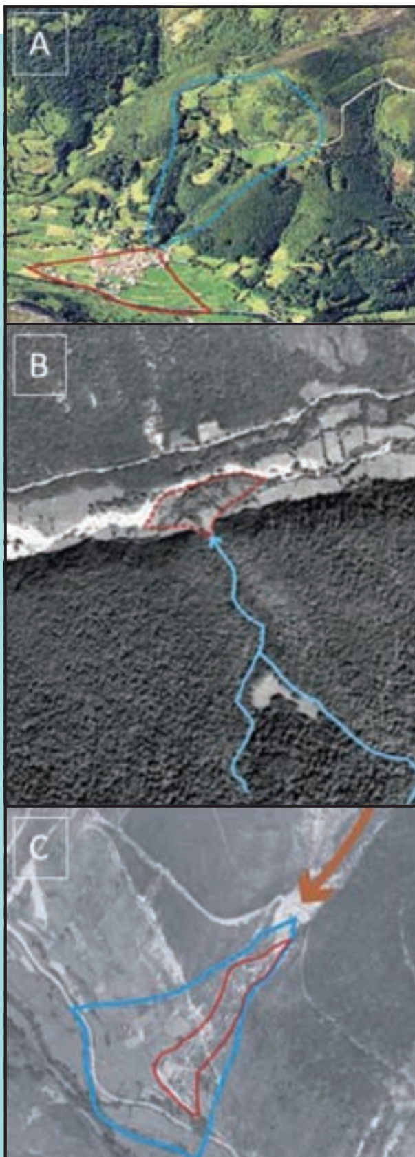
Figura 187. Criterios empleados en la identificación de abanicos aluviales: A) morfología de abanico (Caso, Asturias), B) desvío de canal fluvial en desembocadura de valle de Degaña (Asturias) y C) depósitos recientes (perímetro rojo) en un abanico aluvial del valle de Degaña.
