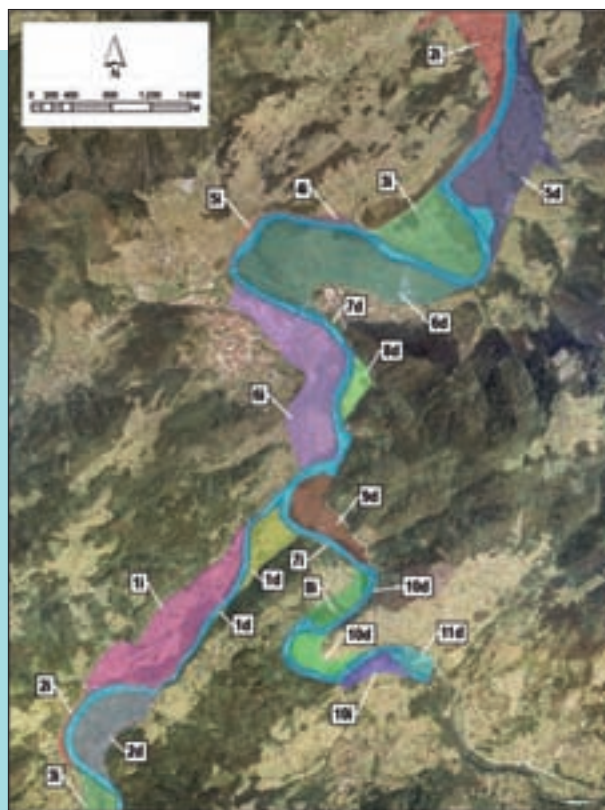
Figura 107. Propuesta de subdivisión de una llanura aluvial en diferentes unidades inundables.
