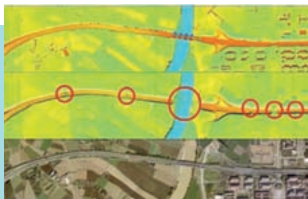
Figura 11. Detección y eliminación de puentes, pasos elevados y obras de drenaje (fuente: INCLAM).
