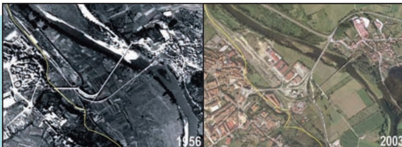
Figura 90. Posteriormente al año 1956 el límite de la zona inundable (línea amarilla) ha sido parcialmente enterrado por rellenos artificiales ligados a un polígono industrial y varias infraestructuras viarias (río Nalón en Pravia, Asturias).
