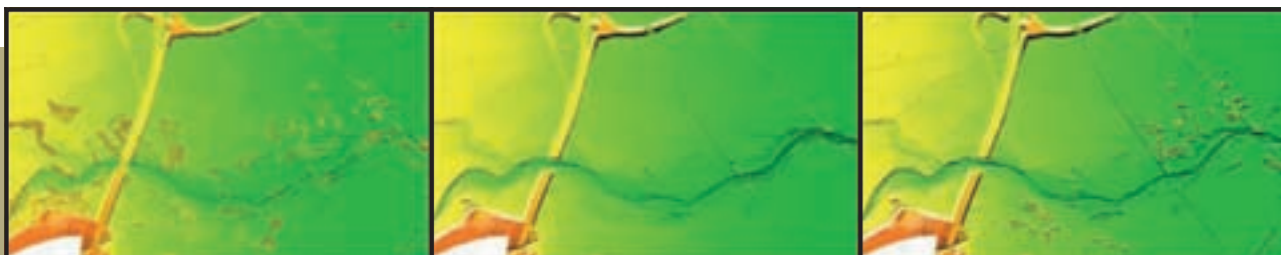
Figura 225. Ejemplo de MDS, MDT y MDT con edificaciones (de izquierda a derecha).
