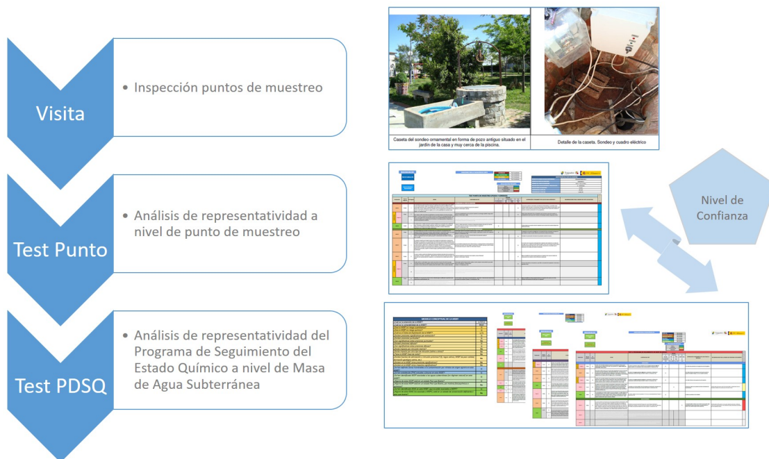
Figura 6. Proceso de los trabajos de diagnosis de la representatividad del programa de seguimiento del estado químico. Punto del PDSQ en la MSBT Tierra de Barros (DH Guadiana).
