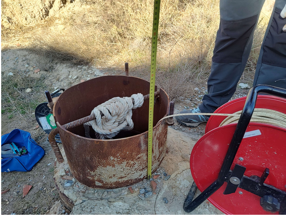
Figura 4. Medida de nivel piezométrico en los trabajos de campo de la modelación matemática de la MSBT Baza-Freila-Zújar.
