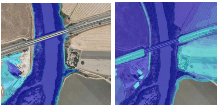
Figura 16.- Puente de la A4 sobre el río Guadalquivir en Córdoba, con capacidad suficiente para la avenida de periodo de retorno de 10 años (izquierda) e insuficiente para la avenida de periodo de retorno de 500 años (derecha)
