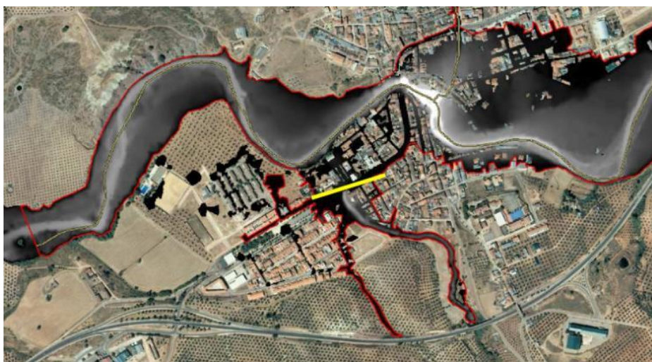
Figura 14.- Ejemplo de incorporación a la zona inundable final de los afluentes con riesgo (incluidos en la simulación)
