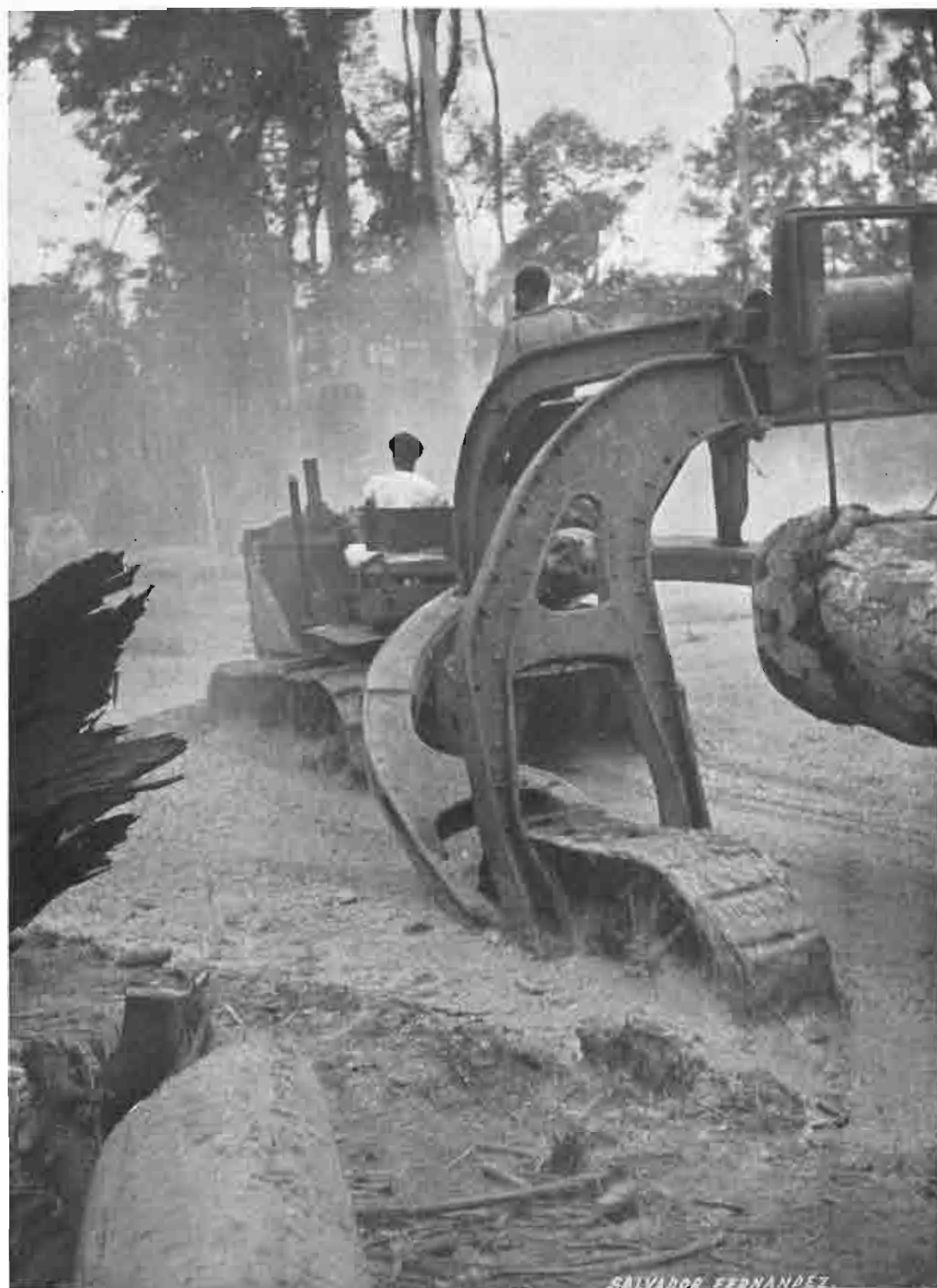
5.—Transporte de maderas mediante tractores.
