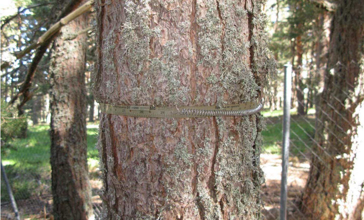
Dendrómetro manual o cinta diamétrica utilizada para la medición de crecimientos del tronco.
