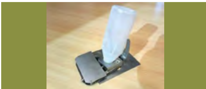
Figura 14. Prototipo de aplicador de estimulante en pasta.
