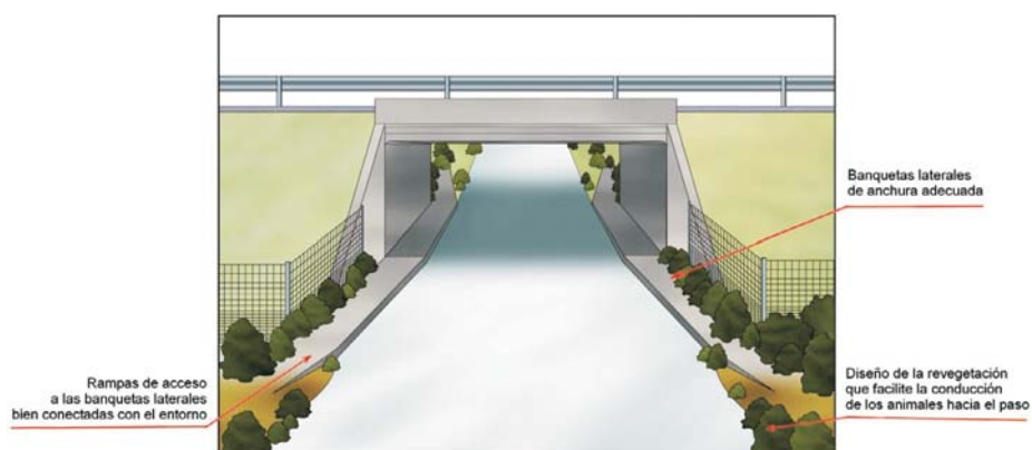
Figura 4.7. Principales aspectos a controlar en la fase de construcción de una estructura de drenaje adaptada para facilitar el paso de animales terrestres.
