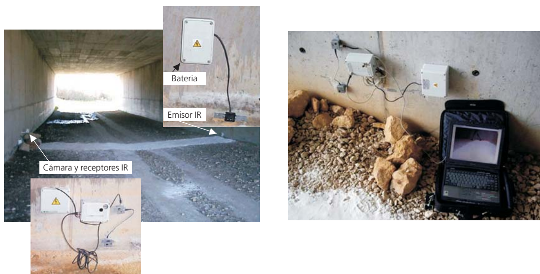
Figuras 4.19. Montaje de un sistema fotográfico en un paso inferior multifuncional y descarga de los datos de la cámara digital a un ordenador portátil. Fotos: TEG-UAM.
