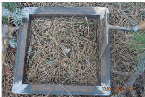
Figura II.3.2.1. Descripción del proceso de recogida de muestras del Horizonte Orgánico
