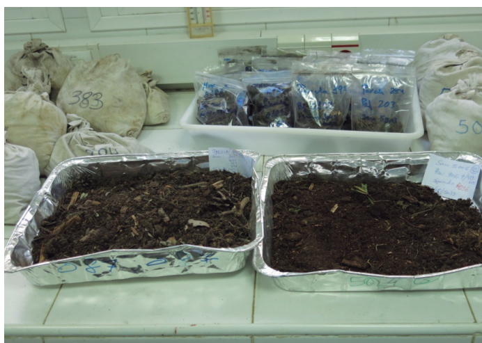
Figura II.3.3.1. Las muestras llegan al laboratorio debidamente identificadas se vierten en bandejas de aluminio para su secado al air y se remueve la muestra para su homogenización. A continuación se separa una submuestra en bolsas de polietileno que se seca a 65C° para la determinación del Carbono Orgánico total. El resto de la muestra se seca en estufa a 102C° para la determinación de Materia Seca (M.S)
