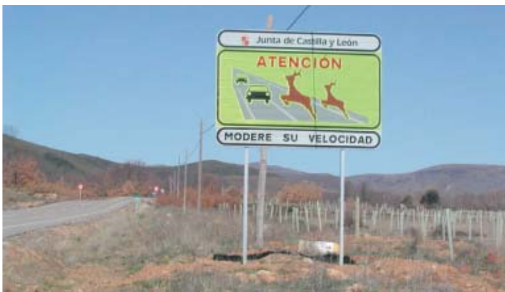
Figura 17.1 – El mensaje de advertencia se ha destacado mediante un panel llamativo y de grandes dimensiones. Foto: Junta de Castilla y León.
