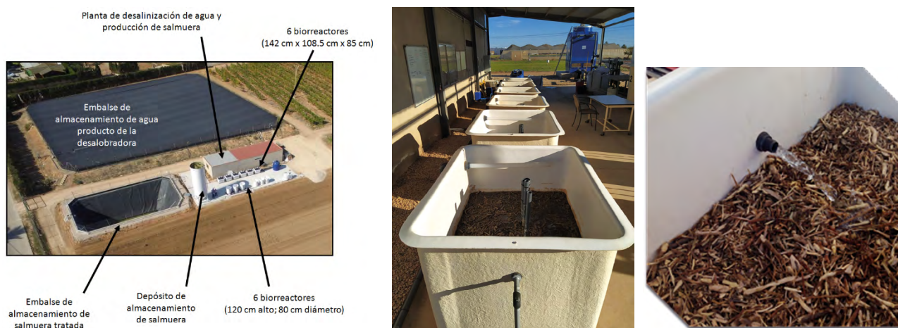
Figura 6. Planta Piloto ubicada en la Estación Experimental Agroalimentaria Tomás Ferro de la ETSIA-UPCT. Izquierda (a): vista aérea de la Planta Piloto con sus diferentes componentes. Centro (b): vista de los biorreactores. Derecha (c): detalle de la madera y la entrada de salmuera en un biorreactor.
