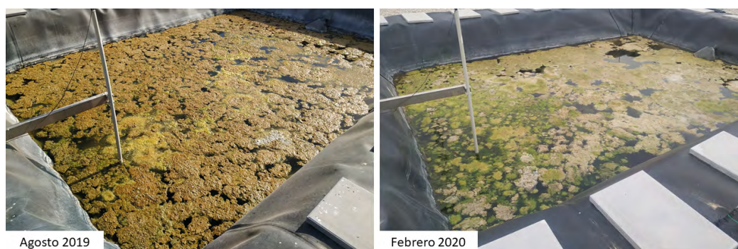
Figura 7. Crecimiento de algas en la Fase II de flujo superficial en dos fechas diferentes (agosto 2019 y febrero 2020).
