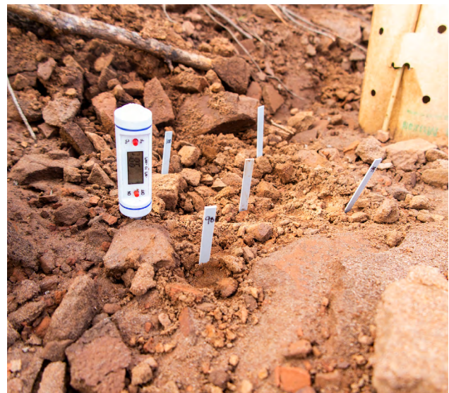
Figura 7. Termómetro para medir la temperatura del suelo y cebos insertados para evaluar la actividad alimentaria de los invertebrados edáficos.
