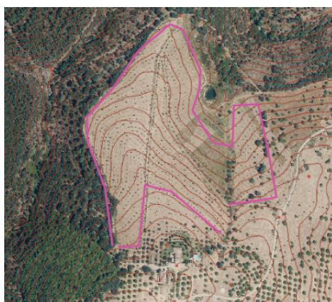
Figura IX.5. Ortofoto 2019 donde se ven las líneas de cultivo en keyline en relación con las curvas de nivel en la parcela A.
