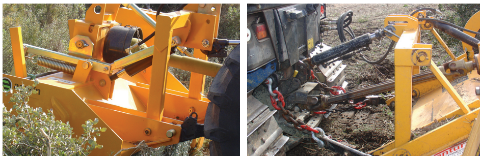
Figura 21.7. Desbrozadora de martillos con y sin protección del cardán (fotos: J Pemán).
