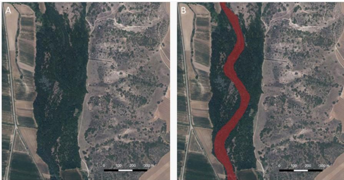
Figura 1.10 Cálculo estimado de la superficie ocupada por la vegetación en una sección del tramo bajo del río Bornova. La vegetación ribereña no puede distinguirse de la no riparia y no es posible la identificación mediante fotointerpretación de los diferentes tipos de vegetación de la imagen. Se muestra sombreada en rojo la fotointerpretación de la superficie aparentemente ocupada por vegetación riparia. Los resultados de estos cálculos de área son inexactos, aunque pueden llegar a ser útiles bajo las condiciones descritas en el texto. Fuente: elaboración propia a partir de ortofotografías del PNOA.
