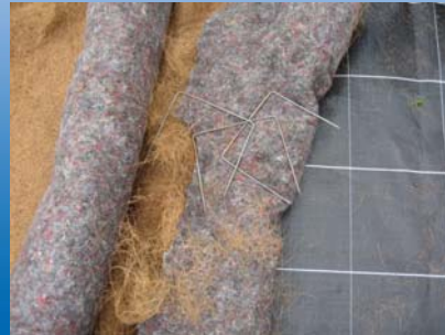
GEOTEXTILES En zonas de pendiente o con orografía o acceso más difícil
