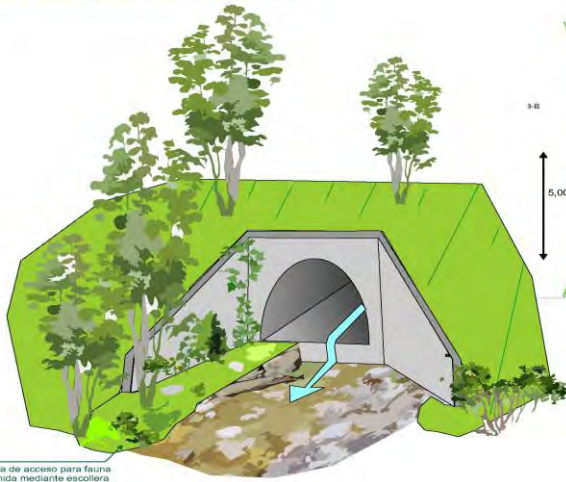
Rampa de acceso para fauna sostenida mediante escollera, gravas y suelos fijados por malla de tripe torsión y piquetas metálicas.
