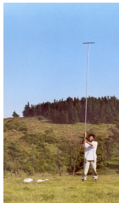
Figura 1 Sonda de presondeo en fibra de vidrio (diámetro: 19 mm, longitud: 105 cm; izquierda) o en acero (diámetro 30 mm, longitud: 10 m; derecha). Autor: Xabier Pontevedra Pombal.
