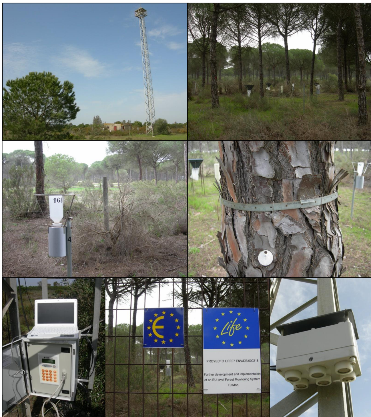
FIG 7 : Torre meteorológica. Parcela interior. Acumuladores de deposición. Dialdendro. Data-logger. Dosímetros pasivos
