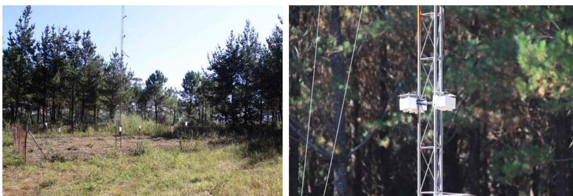
Figura 38: Izq.: Localización de la parcela exterior instrumentada. Dcha.: Dosímetros expuestos en la torre meteorológica.
