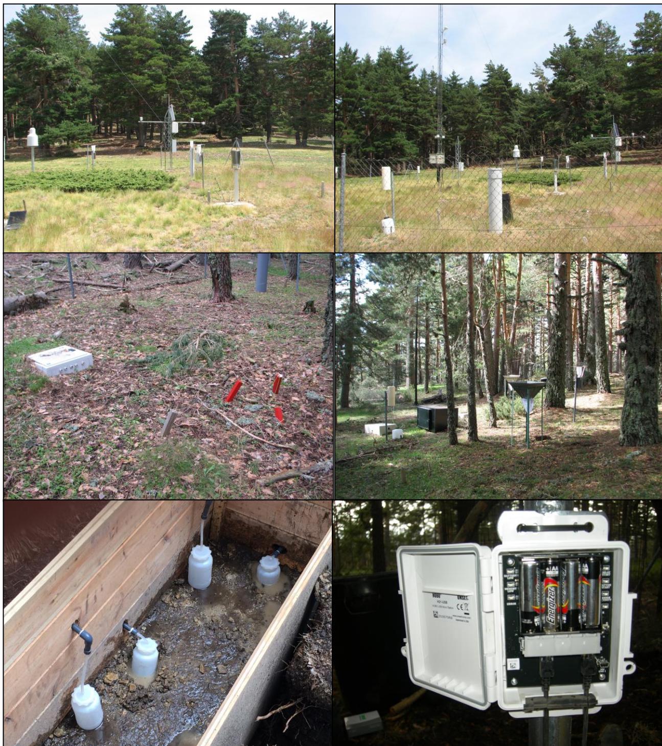
FIG 7: Parcela exterior. Pluviómetros, captadores e instrumentación meteorológica. Parcela interior. Lisímetros, sondas de humedad, captadores de desfronde y acumuladores. Lisímetro de gravedad. Sonda de humedad y temperatura del suelo
