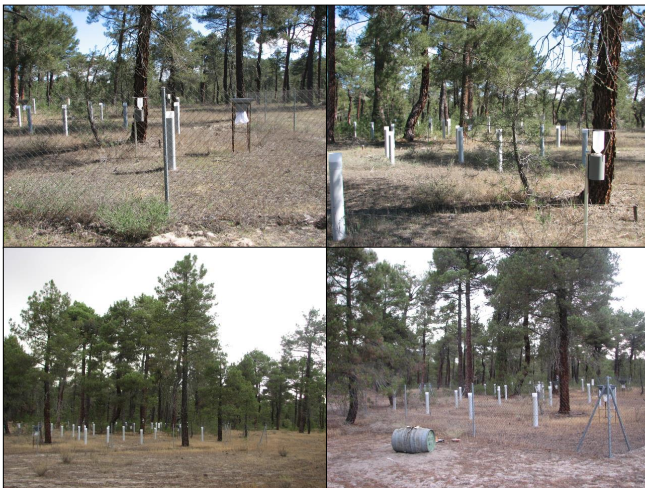
FIG 7: Parcela interior. Acumuladores de deposición. Captador de desfronde. Pluviómetros
