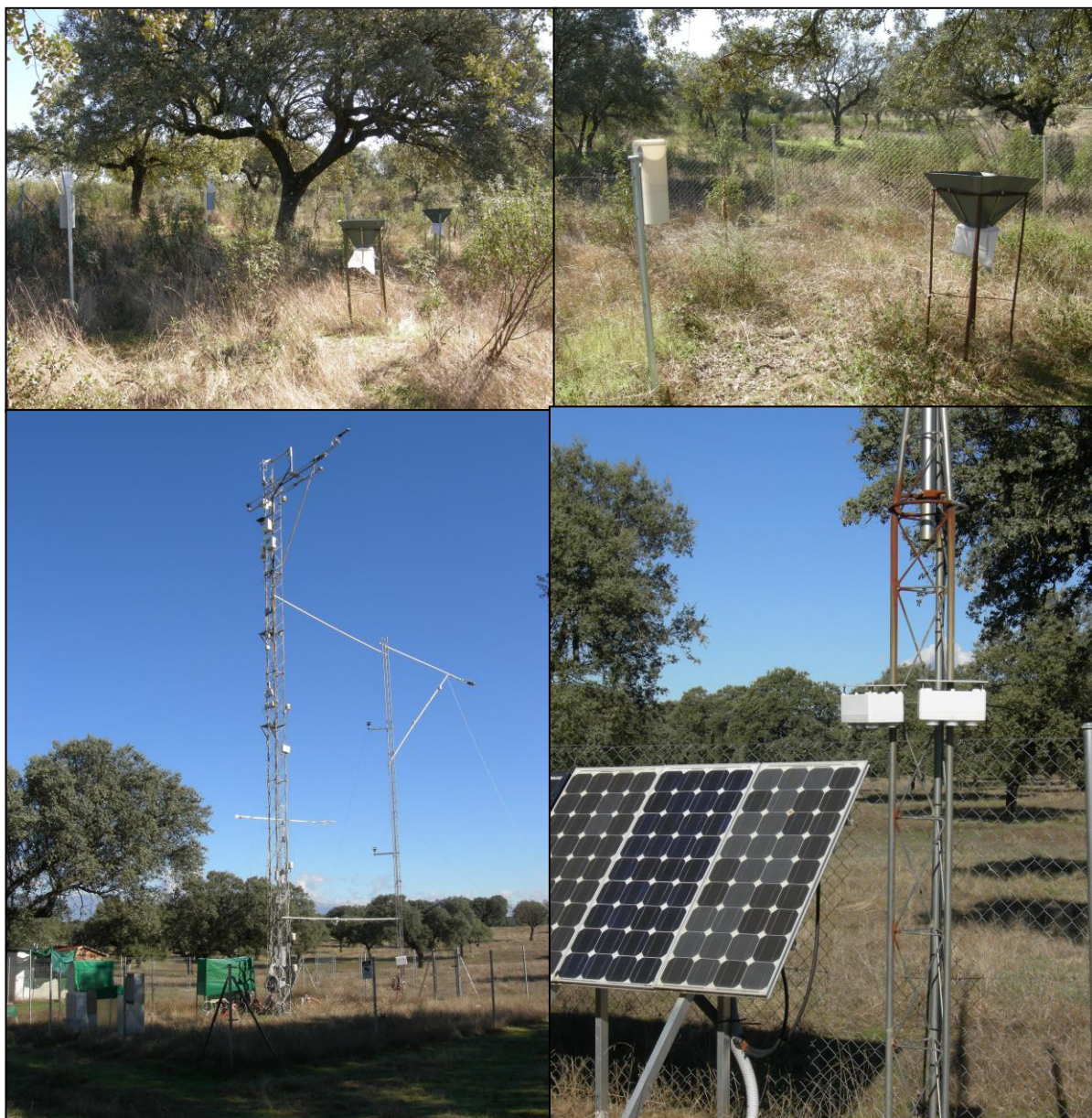
FIG 7a: Parcela interior. Acumuladores de deposición. Pluviómetro y captador de desfronde. Parcela exterior, torre meteorológica y de flujos, placas solares de alimentación y dosímetros pasivos.
