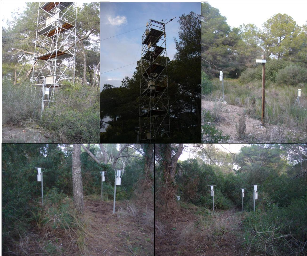
FIG 7: Parcela exterior. Torre meteorológica, acumuladores y caja de dosímetros. Parcela interior.
