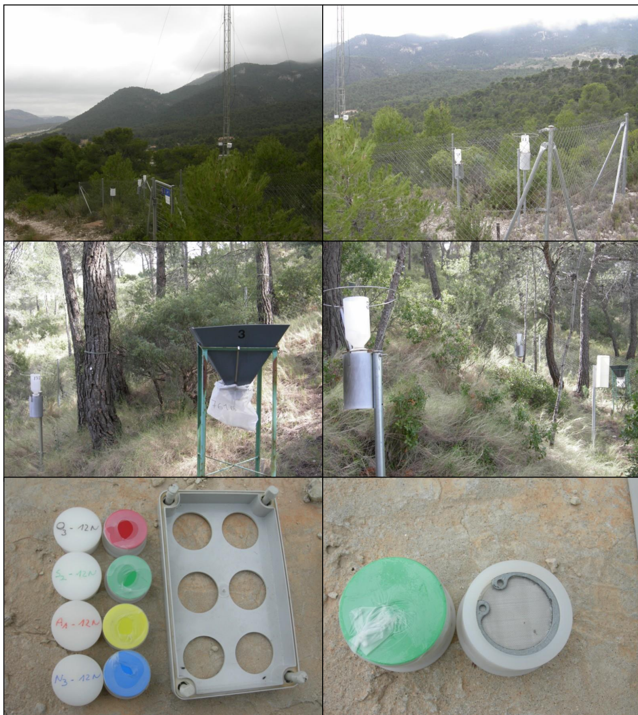
FIG 7: Parcela exterior, torre meteorológica y captadores. Parcela interior, acumuladores de deposición y captador de desfronde. Dosímetros pasivos
