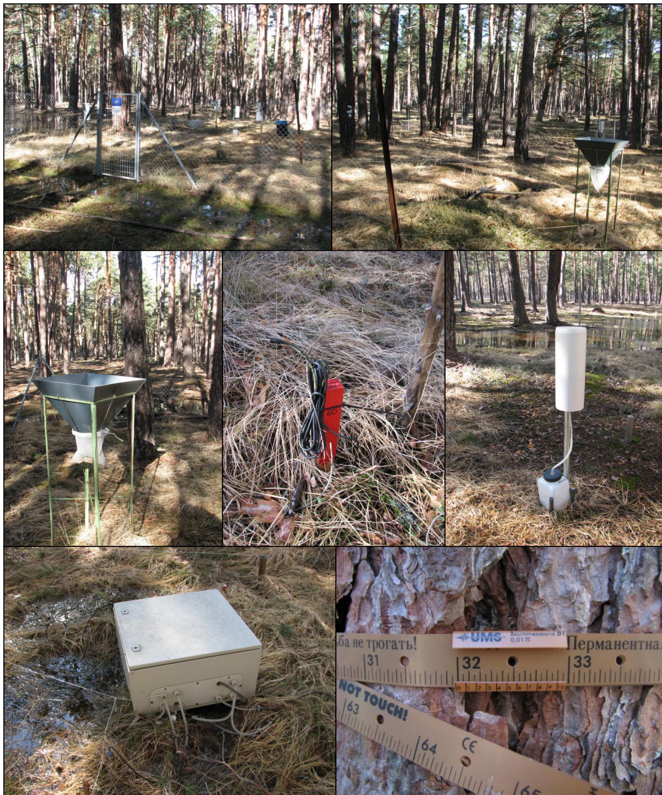
FIG 7: Parcela interior. Acumuladores de deposición. Captador de desfronde. Sonda de humedad. Pluviómetro. Caja de lisímetros. Dialdendro
