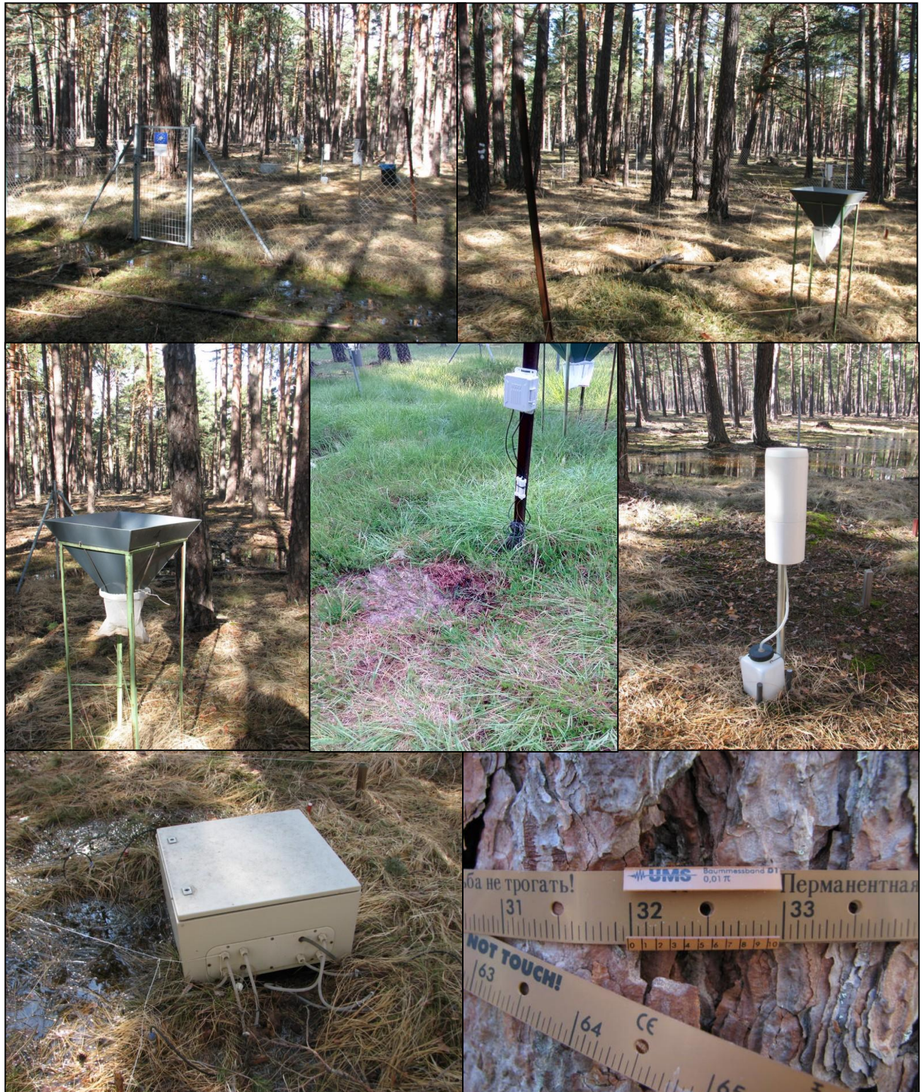
FIG 7: Parcela interior. Acumuladores de deposición. Captador de desfronde. Sonda de humedad. Pluviómetro. Caja de lisímetros. Dialdendro
