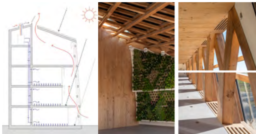
Figura 4: Esquema de funcionamiento de los espacios intermedios de regulación térmica en situación de verano (izq.) y detalles de la galería y del lucernario de ventilación del office-mirador (dcha.). Fotografías: Héctor Santos-Díez.
