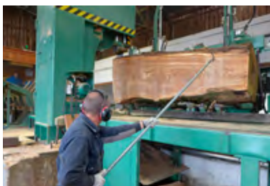
Foto. Sierolam. Proceso inicial de corte del tronco para la obtención de tablones y posterior secado al aire.
