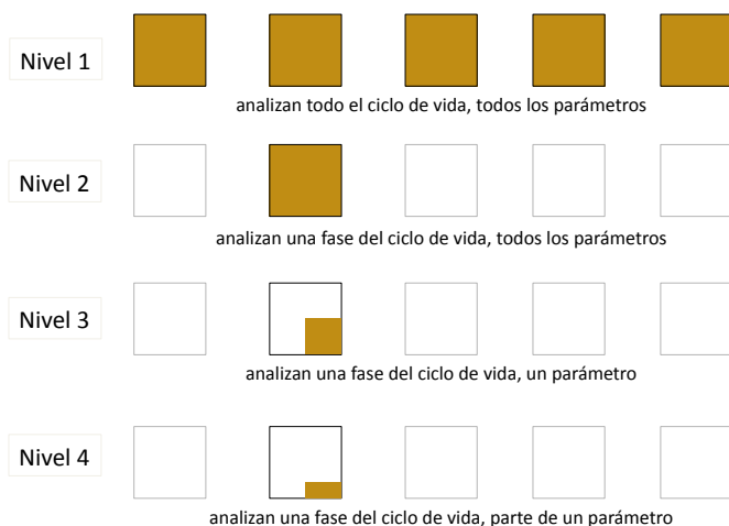
Figura 12. Esquema de los sistemas de certificación ambiental de edificios, según abarcan más o menos el ciclo de vida (Societat Orgànica).
