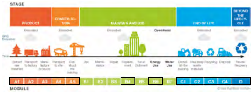
Figura 13. El ciclo de la vida del edificio. Tomado de Lifecycle stages of building carbon. Data source: BS EN 15978:2011 - Source: Bowles, Cheslak and Edelson.
