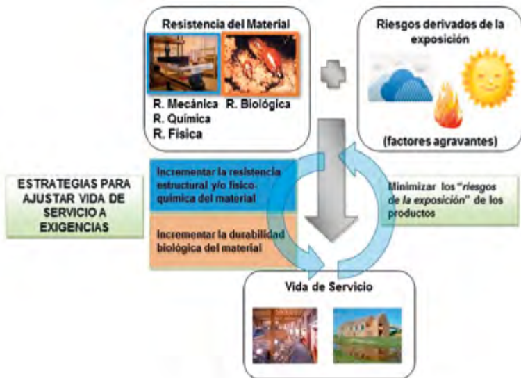
Figura 2. Esquema general de optimización de la vida útil.
