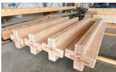
Foto. X-lam Dolomiti. Fabricación de pilares de castaño.
