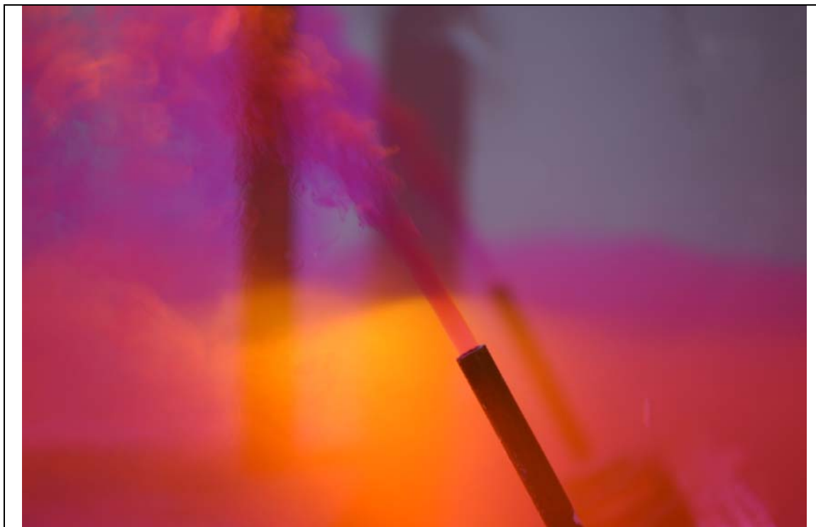
Figura 3: Turbulencias en el campo cercano de un chorro sumergido. El efluente se ha marcado con un colorante (Rodamina) 3
