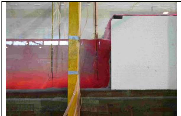
Figura 9: Ensayo en canal (2D) de un vertido por rebose sobre un acantilado
