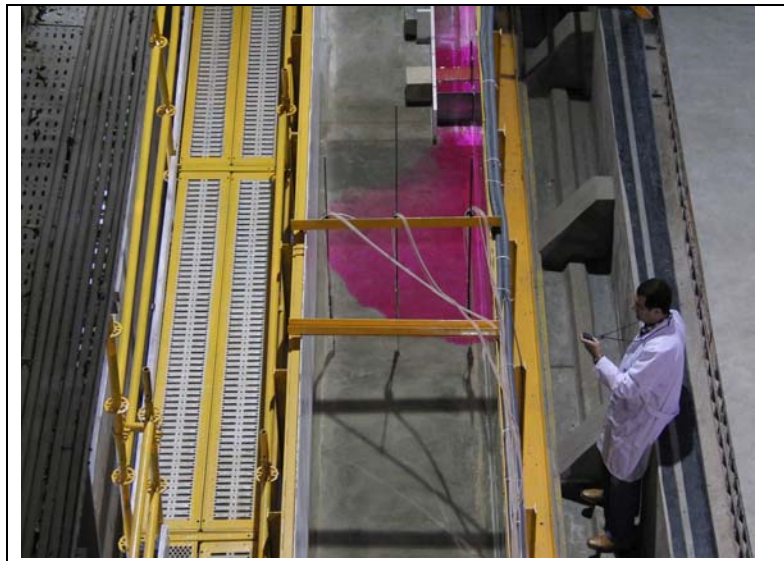
Figura 11: Vertido en una playa mediante un canal de descarga. Se aprovecha la existencia de un plano de simetría del problema haciéndolo coincidir con un contorno plano del modelo
