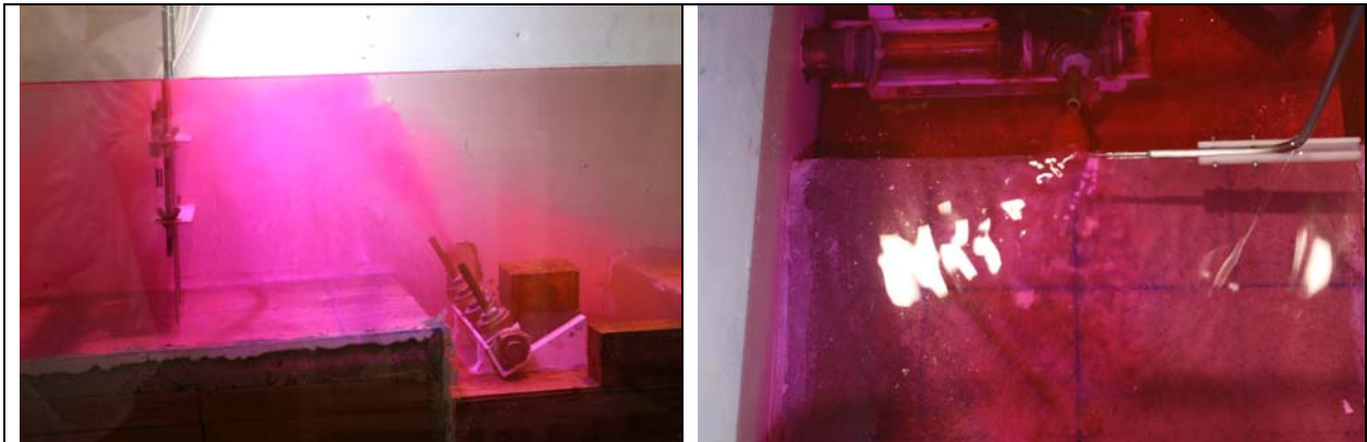
Figura 10: Influencia en el comportamiento del chorro del impacto con la superficie en su trayectoria ascendente.
