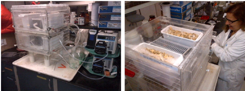
Figura 1. Prototipo utilizado en la recuperación de amonio y colocación del estiércol y la solución ácida en el interior del compartimento.
