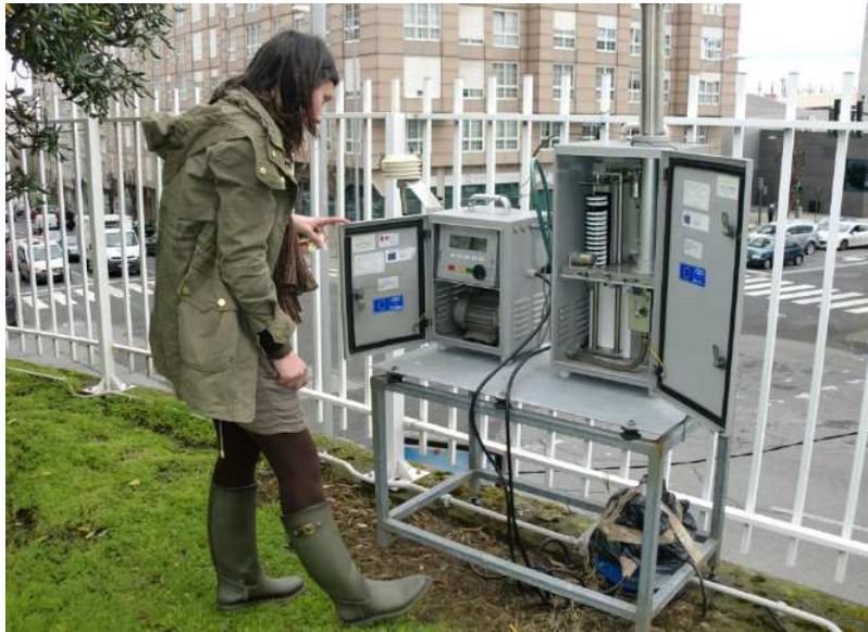
Imagen 17. Derenda LVS 3.1 a la izquierda y CAV-A/MSB MCV a la derecha, ambos con cabezal PM 10 en la estación Riazor
