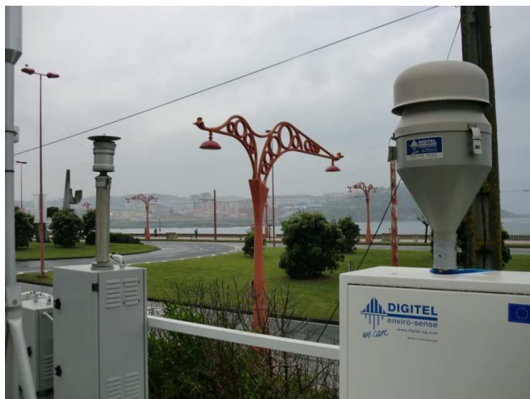
Imagen 15. Captadores gravimétricos con cabezales PM_{10} y PM_{2,5} Torre de Hércules, CAV Digital DHA-80 y Derenda Aguirre LVS-3.1
