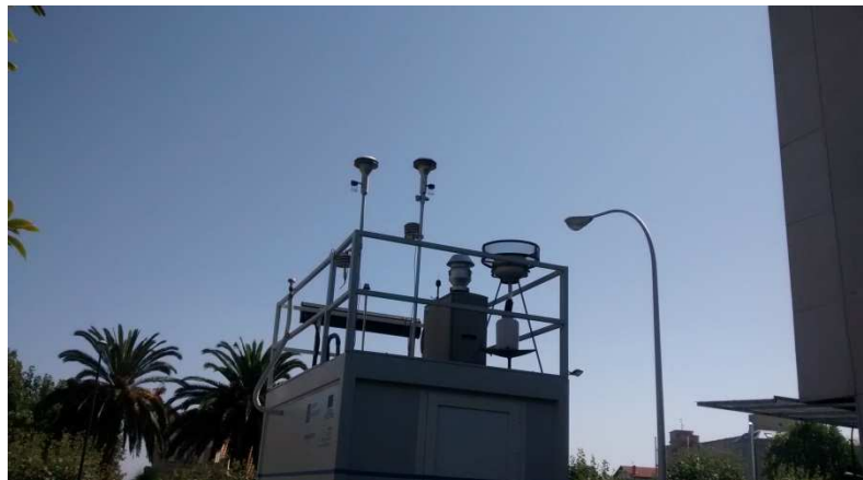
Imagen 12. Equipo colector de agua de lluvia (captador de polvo sedimentable) en Riazor.
