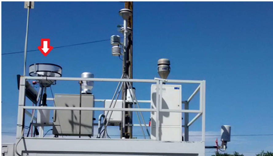
Imagen 13. Equipo colector de agua de lluvia (captador de polvo sedimentable) en Torre de Hércules.
