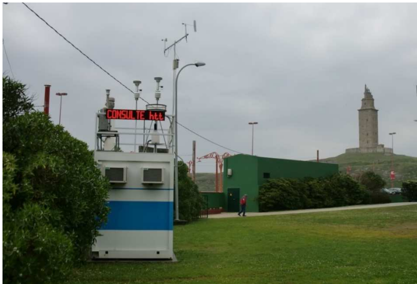
Imagen 16. Captadores gravimétricos con cabezales PM_{10} y PM_{2,5} en la estación Torre de Hércules.
