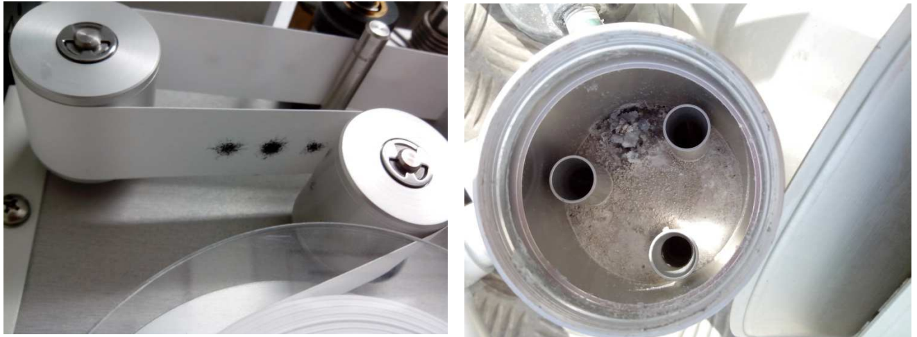
Imagen 11. Papel de filtro y cabezal de PM 10 del analizador automático de Torre de Hércules con sal cristalizada
