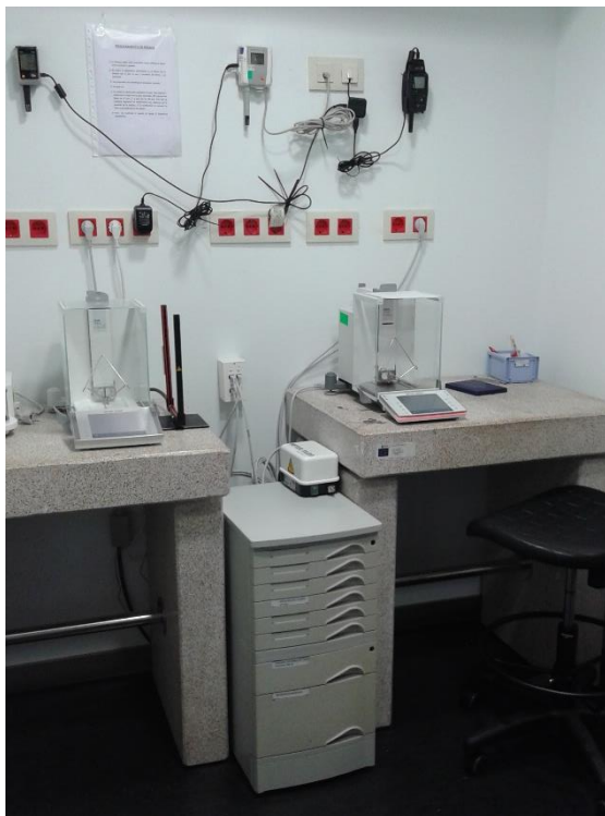
Imagen 4. Sala de balanzas del LMAG con temperatura y humedad controladas.
