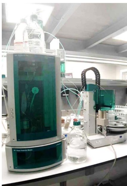
Imagen 5. Cromatógrafo iónico 930 Compact IC Flex del LMAG.
