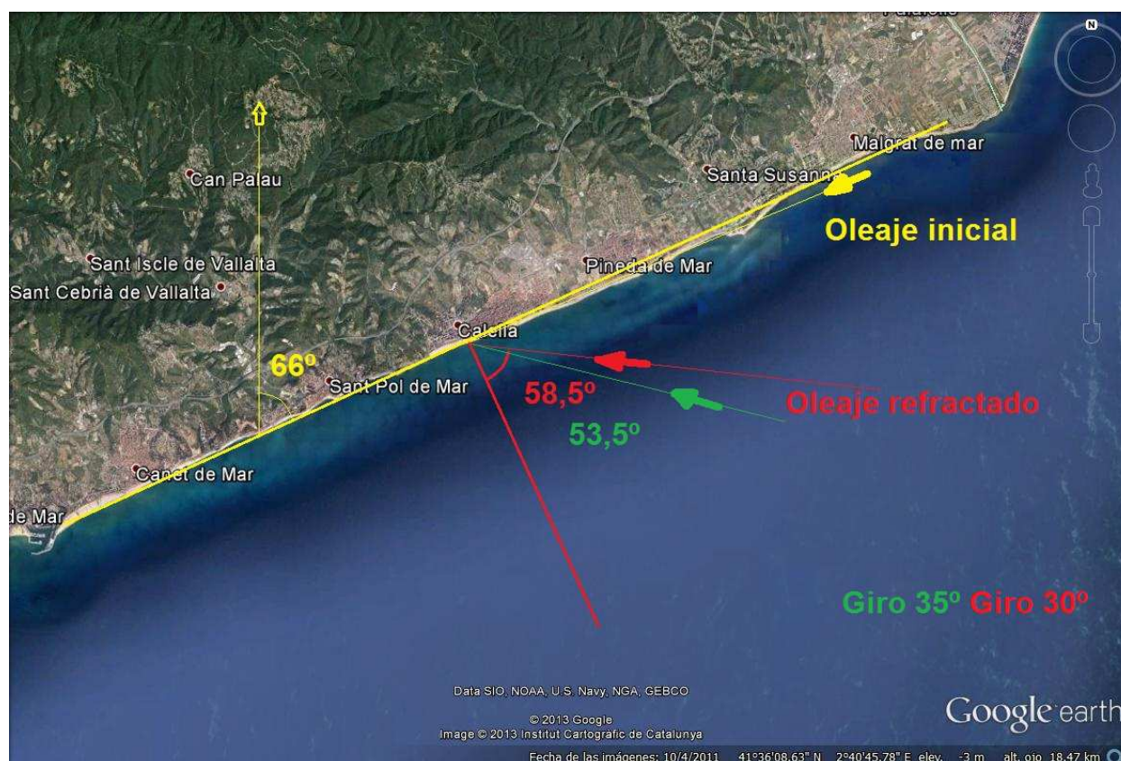
Figura 6.3: Configuración general de las playas del primer tramo, sistema litoral, del Maresme entre Malgrat de Mar y Arenys de Mare y dirección de oleaje de mayor fetch (foto: Google Earth)
