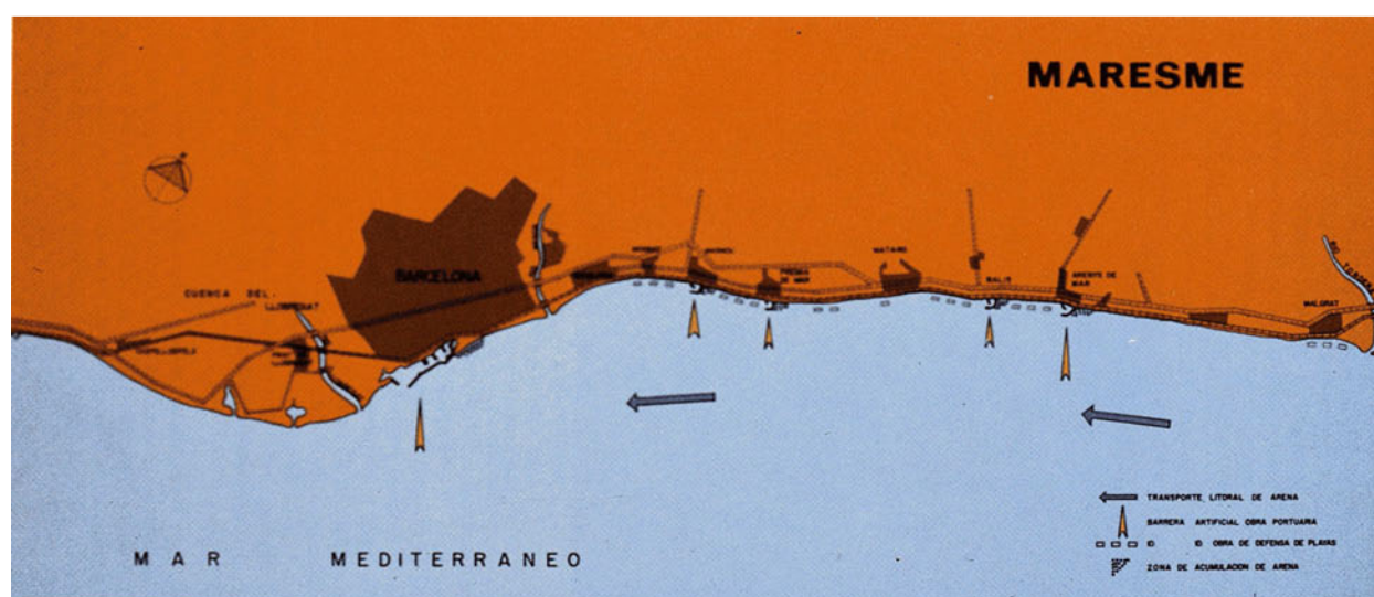
Figura 1.4: Plano esquemático de las barreras al transporte de sedimentos, obras de defensa costera y dirección del transporte litoral de sedimentos (MOPU 1985)
