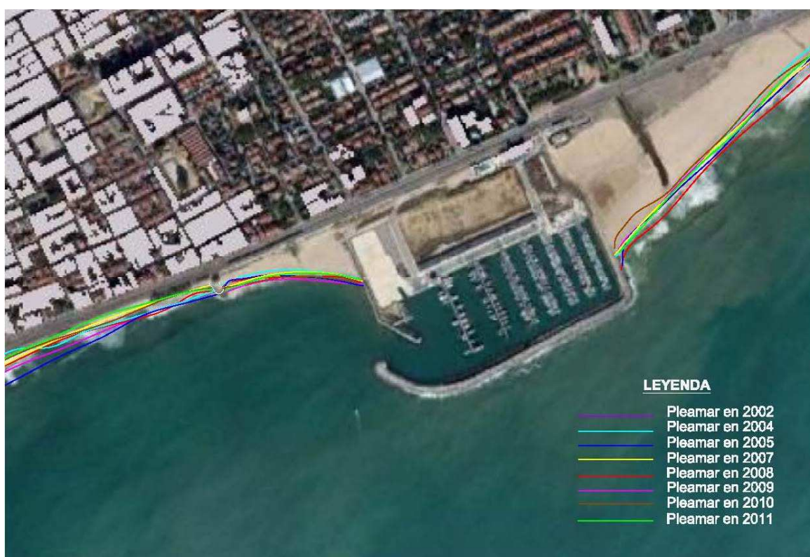
Figura 5.39: Evolución de las playas en torno al puerto de Premiá de Mar, 2002 a 2011- detalle (foto: Institut Cartorgràfic de Catalunya y Google Earth)
