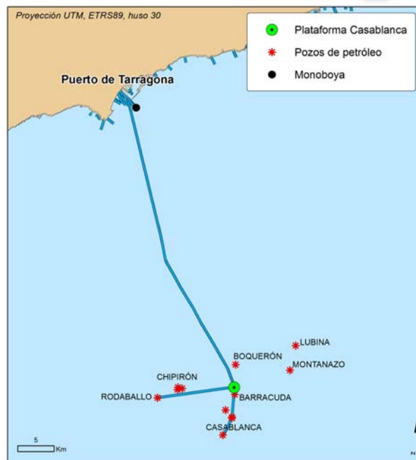
Figura 16. Sistema de tuberías que unen la explotación Casablanca y la monoboya con el puerto de Tarragona
