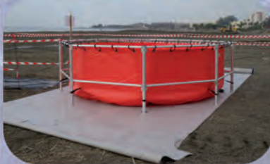
DEPÓSITOS DE ALMACENAMIENTO DE RESIDUOS
