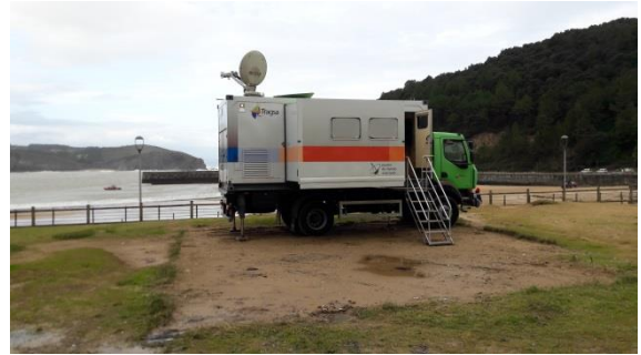
Ilustración 3. Puesto de mando avanzado (Tragsa).
