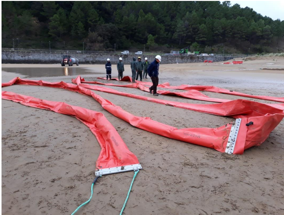
Ilustración 17. Barreras tendidas y empatadas preparadas para el largado.
