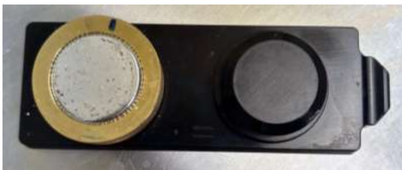
Figura 23. Filtro de aluminio con muestra colocado en el soporte del LDIR.
