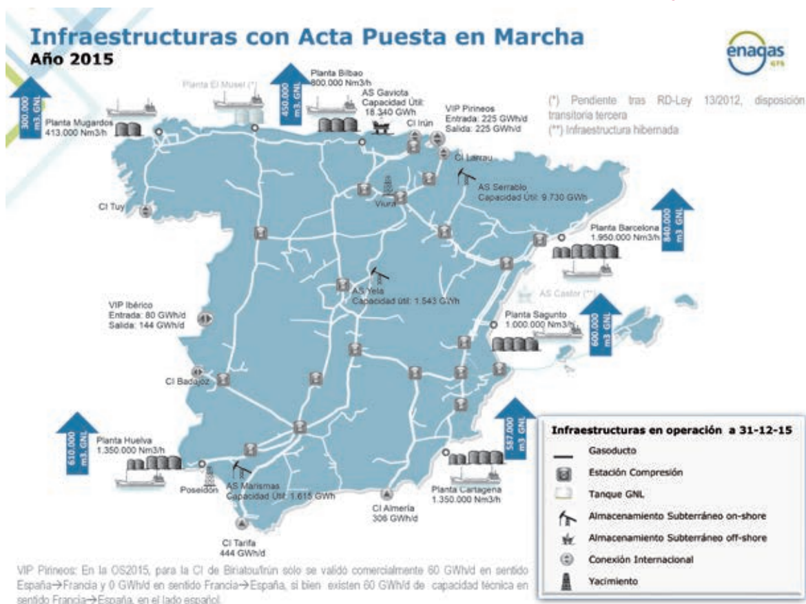
FIGURA 11.4 INFRAESTRUCTURAS CON ACTA PUESTA EN MARCHA. AÑO 2015
