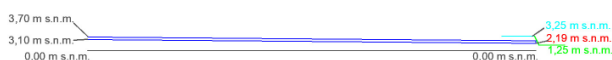
Ilustración 20. Perfil longitudinal de las tuberías con las cotas de entrada y salida (pendiente 0,90%).
