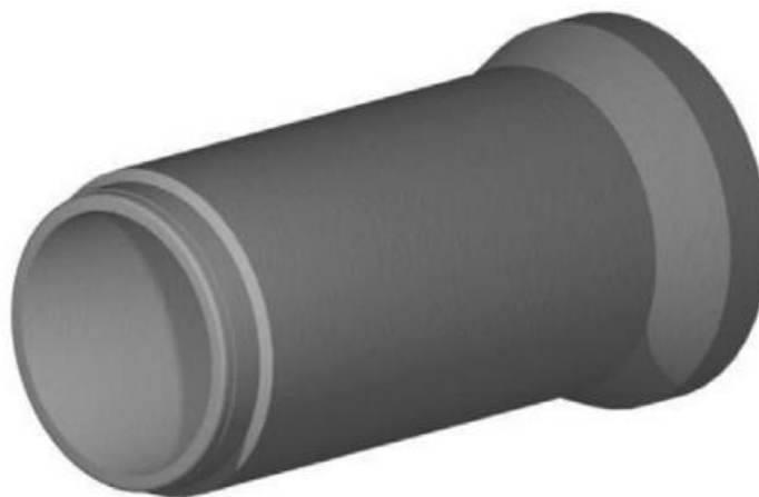
Ilustración 19. Imagen de tubería de hormigón armado con campana y junta de goma.
