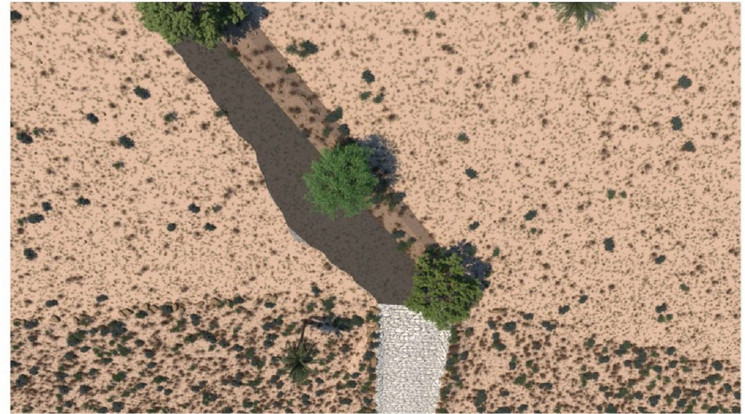
Planta A.1.2.: Vista en planta de caballón que dispondrá de banda de vegetación de 4 m aguas arriba y 2 m aguas abajo. Se incluye el propio caballón. Incluye detalle de entrega de agua a cauce, mediante bajante o protección de escollera con mortero.
