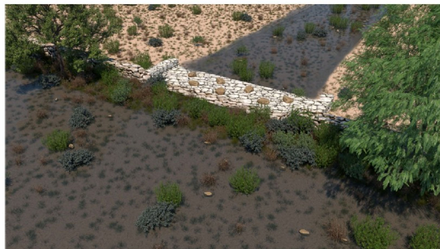
Planta A.2.4.: Vista en planta de vertedero revestido con escollera con hormigón insertado en infraestructura transversal tipo muro de piedra en seco. Dispondrá de banda de vegetación de 4 m aguas arriba y 2 m aguas abajo. Dispondrá de cuenco disipador de energía de 1,25 m de longitud ubicado a la salida del vertedero.
