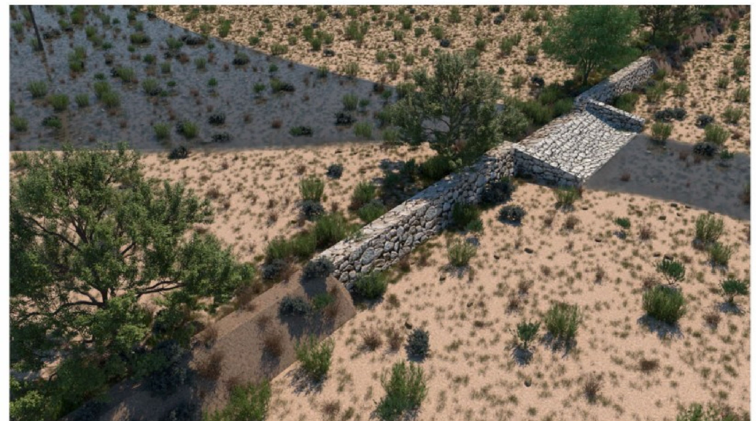
Planta A.2.3.: Vista en planta de vertedero revestido con escollera con hormigón insertado en infraestructura transversal tipo muro de piedra en seco. Dispondrá de banda de vegetación de 4 m aguas arriba y 2 m aguas abajo. Dispondrá de cuenco dissipador de energía de 1,25 m de longitud ubicado a la salida del vertedero.
