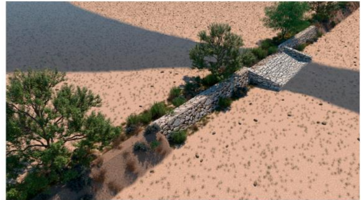
Ilustración 87: Modelo de muro de piedra con aliviadero protegido propuesto. Fuente: Proyecto Técnico.
