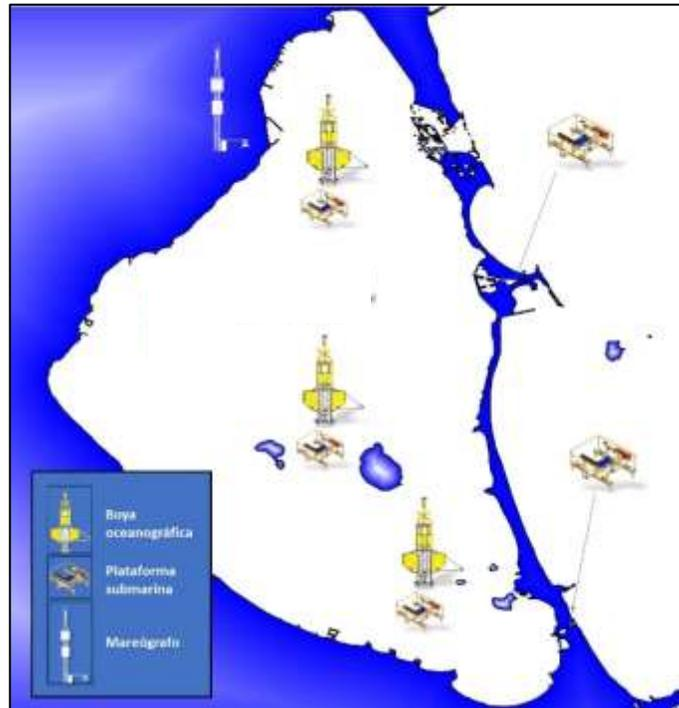
Este novedoso sistema transmite los datos registrados por los diferentes sensores a un servidor del IEO-CSIC en continuo, tiempo casi-real y muy alta resolución temporal, de las variables más relevantes del estado de la masa de agua del ecosistema lagunar: temperatura, salinidad, clorofila a, oxígeno, turbidez, radiación submarina PAR, velocidad y dirección de la corriente, nivel del mar y variables meteorológicas (intensidad y dirección del viento, radiación solar, temperatura, etc.).
