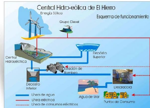
La central hidroeólica Gorona del Viento incluye un parque eólico, un grupo de bombeo, una central hidroeléctrica, dos depósitos y una planta desaladora. El parque eólico puede suministrar energía eléctrica a la red y, además, alimentar un grupo de bombeo que embalsa agua en un depósito elevado como sistema de almacenamiento energético. De este modo se garantiza el suministro eléctrico y la estabilidad de la red, maximizando el aprovechamiento de los recursos renovables.
