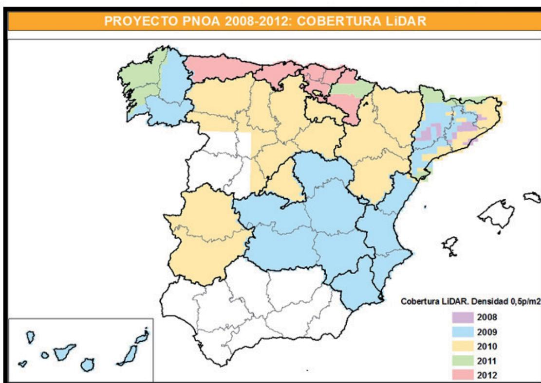
Figura 20: Cobertura LiDAR PNOA (2008-2012) Fuente IGN.
