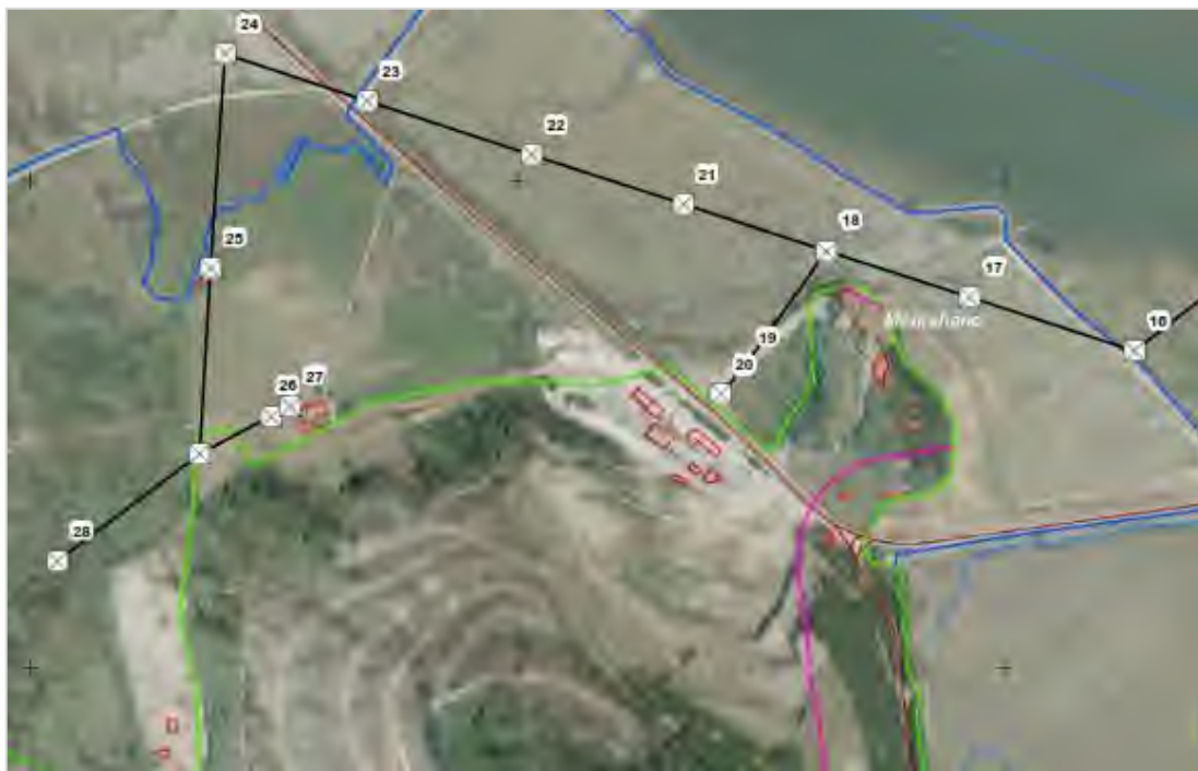
Imagen 2.1. Localización de los apoyos y vanos que se encuentran en el Dominio Público Marítimo-Terrestre de la LMT Treto-Santoña.
