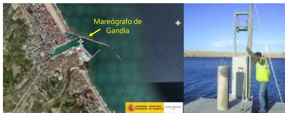
Figura 5. Posición del mareógrafo 3656 en el Puerto de Gandía (izda.) y fotografía de la Estación en funcionamiento (dcha.)
