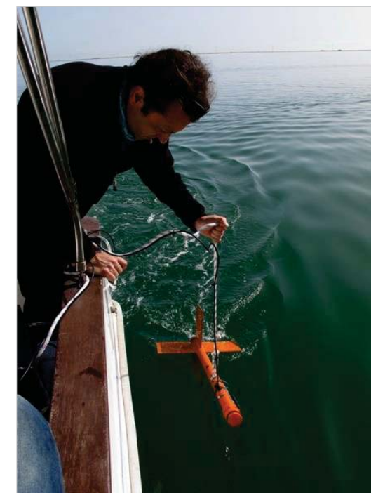
Figura 4: Towfish donde va instalado el transductor del sonar (Foto: © Jordi Sánchez-SUBMON).
