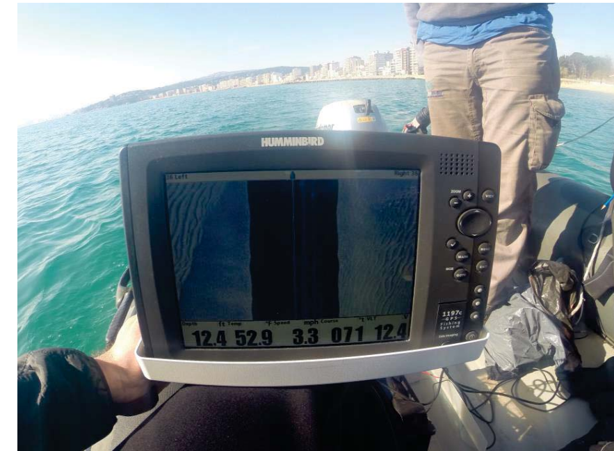
Figura 3: Unidad central del sonar de imagen lateral Humminbird 1197c (Foto: © Andreu Dalmau -SUBMON).
